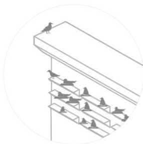
1. Mur anti-tempête avec corniches au profit des oiseaux nichant dans les falaises
